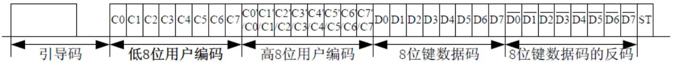
引导码由一个9ms的载波波形和4.5ms的关断时间构成, 它作为随后发射的码的引导, 这样当接收系统是由微处理器构成的时候, 能更有效地处理码的接收与检测及其它各项控制之间的时序关系。编码采用脉冲位置调制方式 (PPM)。利用脉冲之间的时间间隔来区分“0”和“1”。每次8位的码被传送之后, 它们的反码也被传送, 减少了系统的误码率。
